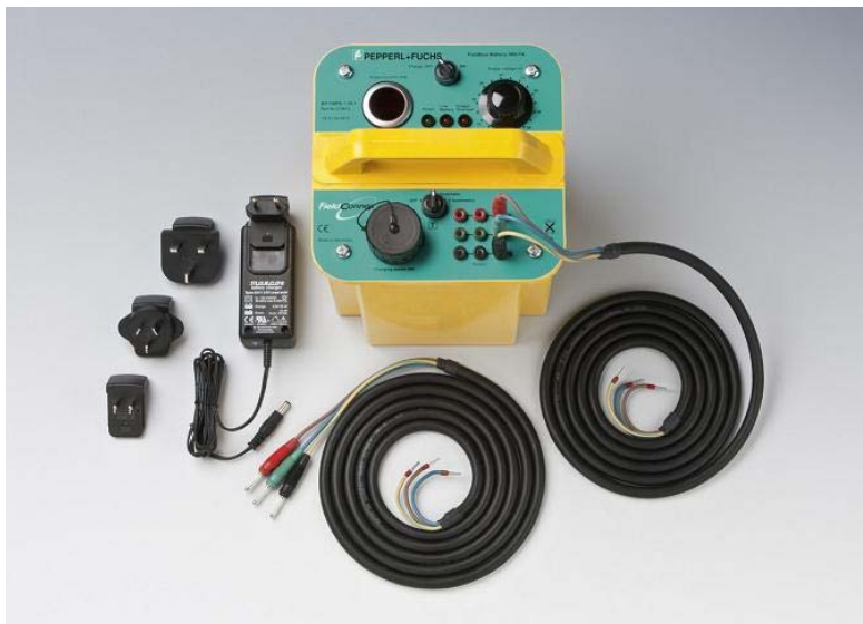
Bild 1: Versorgung für die Arbeit eines ganzen Tages, Aufladung über Nacht: Die FieldConnex Feldbus-Batterie mit komplettem Zubehör. Mit Steckern für den Feldbus und die Diagnose der Feldbusphysik, kann auch die SPS mit Strom versorgen.
