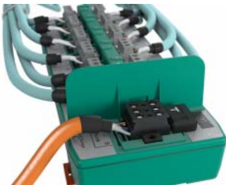
Bild 4: FieldConnex R2 Segment Protector mit Kurzschlusschutz für jeden Spur-Ausgang sowie einfacher Handhabung.
