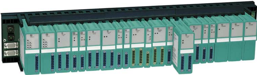
Bild 2: Ethernet Remote I/O mit redundanten Gateways
