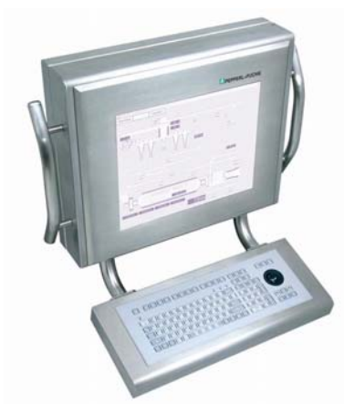
Bild 2: VisuNet Remote Monitore können jetzt auch per ICA mit dem Host verbunden werden
