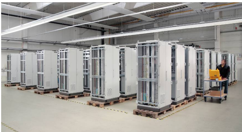
Bild 4: Ein separater FAT-Bereich sorgt für eine ungestörte Abnahme selbst bei größeren Stückzahlen.
