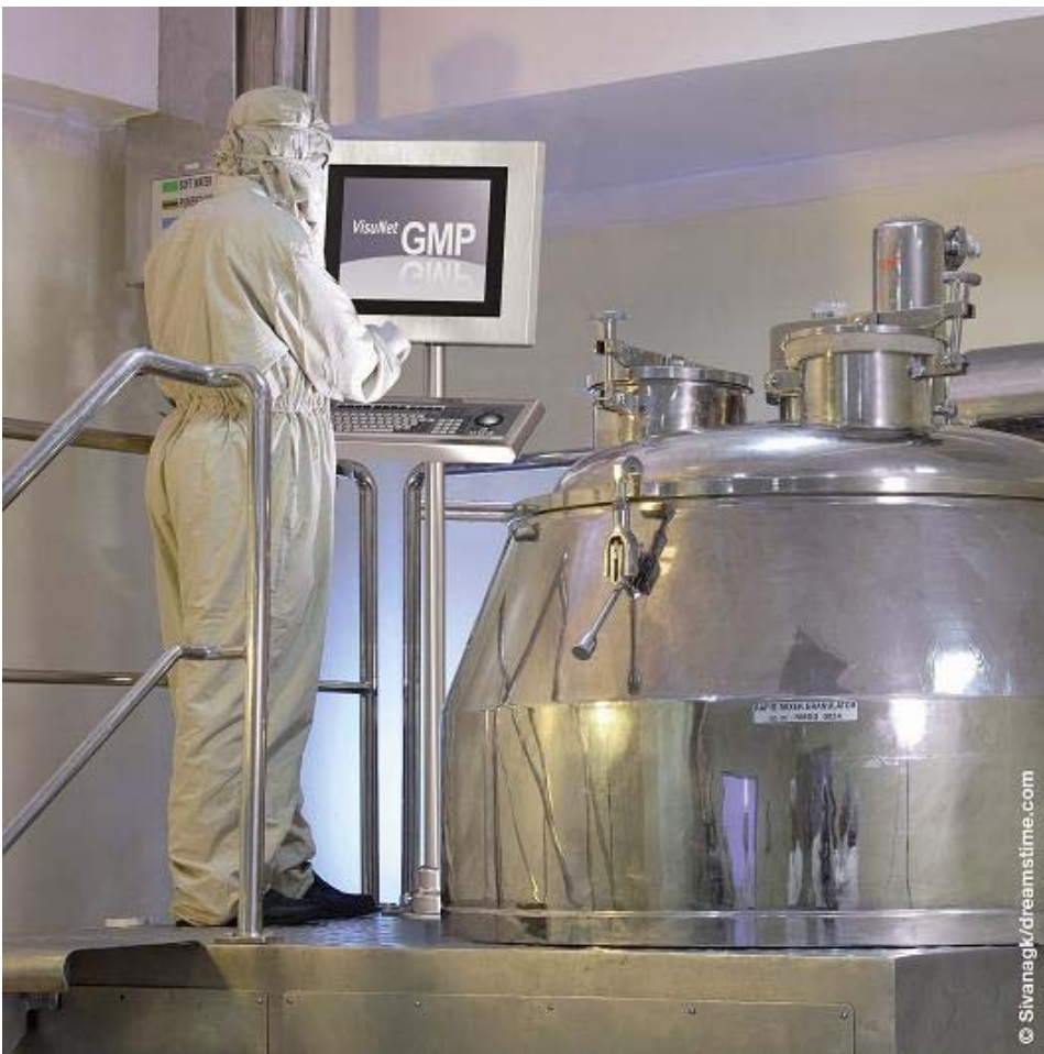
Bild 2: Bedien- und Beobachtungsstationen sind im Produktionsumfeld den gleichen GMP-Anforderungen unterworfen wie die gesamte Anlage
