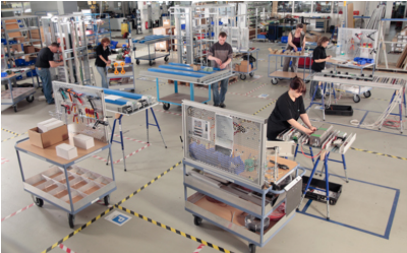
Bild 2: Jeder Arbeitsplatz ist optimal für die jeweilige Aufgabe in der Montagelinie ausgelegt.
