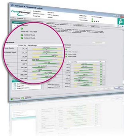
Bild 4: Meldungen und Messwerte mit Farbkodierung nach NE 107: Unterstützt durch das eingebaute Expertensystem findet sich der Installateur auch bei seltener Anwendung schnell zurecht und kann Korrekturen im System geplant und vorausschauend durchführen. Der Feldbus wird zum überwachbaren Anlagenteil.
