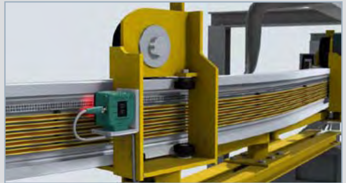
Applikation EHB mit Data Matrix Codeband und PCV Lesekopf zur optimalen Positionierung
